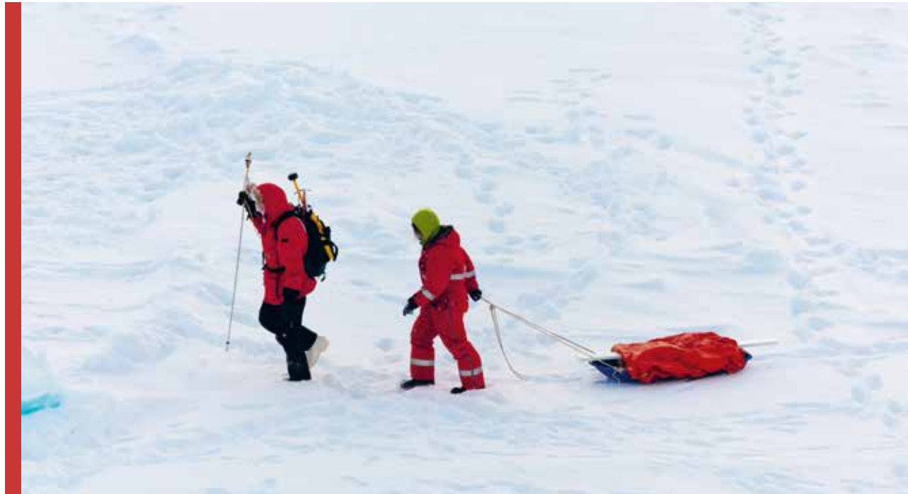
Im ebenen ungestörten Teil einer Eisscholle ist das Vermessen der Eisdicke eine vermeintlich einfache Aufgabe: Ein Forscher geht voran und misst die Schneedicke mit der Magna-Probe; ein zweiter folgt und zieht den Messschlitten.
