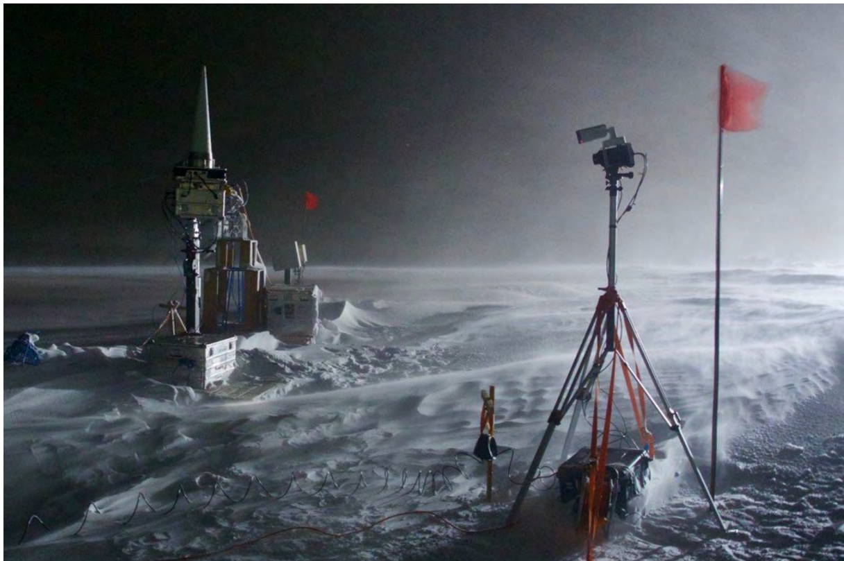
Messaufbau zur Erfassung der Mikrowelleneigenschaften der Schnee- und Eisbedingungen im MOSAiC-Umfeld (Foto: Gunnar Spreen / IUP Bremen).
