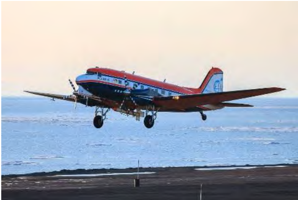
Bild 1: Die Polarflugzeuge Polar 5 und Polar 6 lassen sich mit einem elektromagnetischen Sensor, dem EM-Bird, ausstatten, der während Start und Landung in einem Nest an der Flugzeugunterseite fixiert ist. Über Meereis wird der Sensor dann an einem 70 m langem Schleppseil in 15 Meter Höhe über das Eis geflogen um
