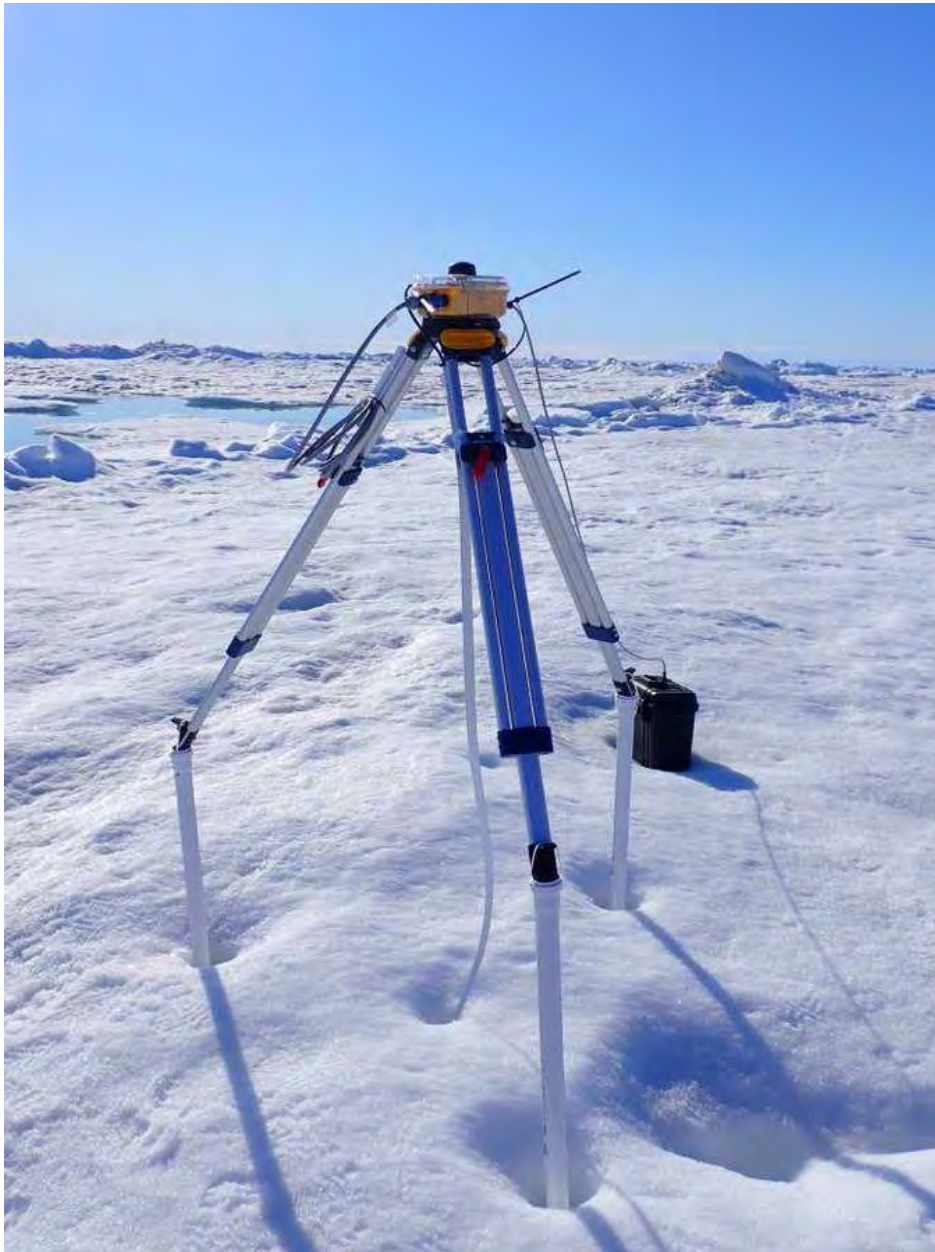
Abbildung 3: Eine digitale Thermistorketteneinheit im alten Zentralobservatorium am 21. Juli. (Foto: Ilkka Matero)
